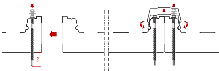
Detalle de Encaje - Joint Detail
